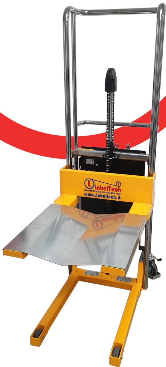
Élévateur manuel, compact et maniable, équipé d'un système de levage avec pompe hydraulique à pédale (ou électrohydraulique) et de roues en polyuréthane de grand diamètre pour des déplacements en douceur (2 fixes et 2 directionnelles avec frein). En retirant le plateau de chargement en V, le chariot peut être utilisé comme chariot élévateur. La pédale de levage peut être positionnée verticalement pour réduire son encombrement et la descente est contrôlée par une vanne avec volant.
