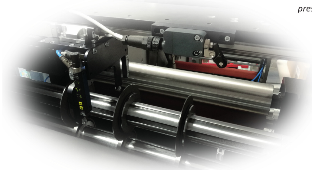
LAVAREDO: sistema di posizionamento automatico lame
