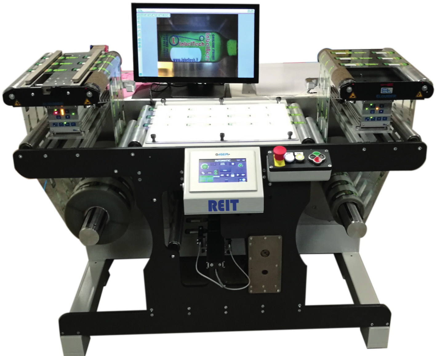
REIT doctoring rewriter con 2 guidanastri e telecamera di ispezione
